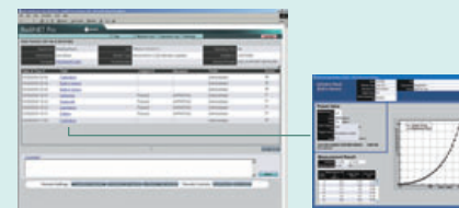
Doppelklick auf einen bestimmten Datensatz ermöglicht in einem separaten Fenster den Zugriff auf Daten aus Kalibrationen, Abnahme- und Konstanzprüfungen und andere Informationen
